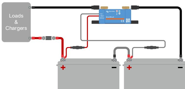
Medición del punto medio de la bancada de baterías
